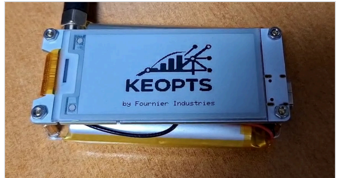
Module autonome. Écran e-paper et liaison LoRa. Prototype en développement.
