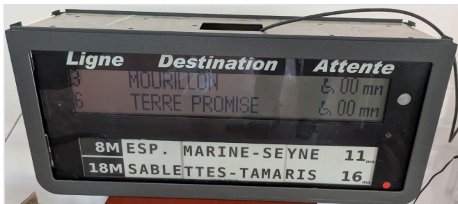
Rénovation d'un afficheur existant. Prototype d'atelier : ancien LCD en haut, nouvel afficheur e-paper en bas.
